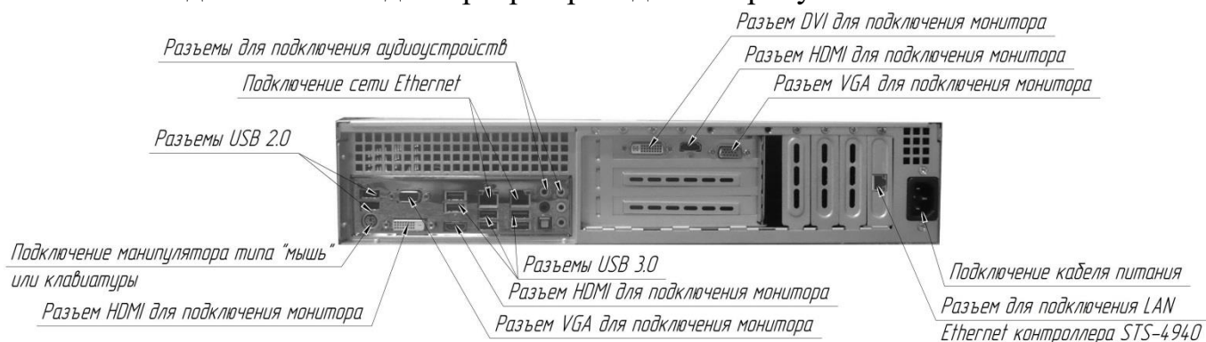
Рисунок 1 – Подключение видеосервера (расположение, внешний вид, типы разъемов и их количество может отличаться от приведенного)
